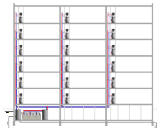
-Figuur 1- Inzet van een boosterwarmtepomp met lagetemperatuurwarmtedistributie
